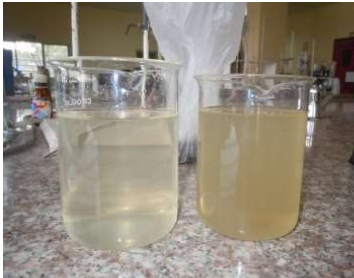
Figura 2-1 Primera etapa de filtración con arena y grava Realizado por: Jiménez Jorge 2016
