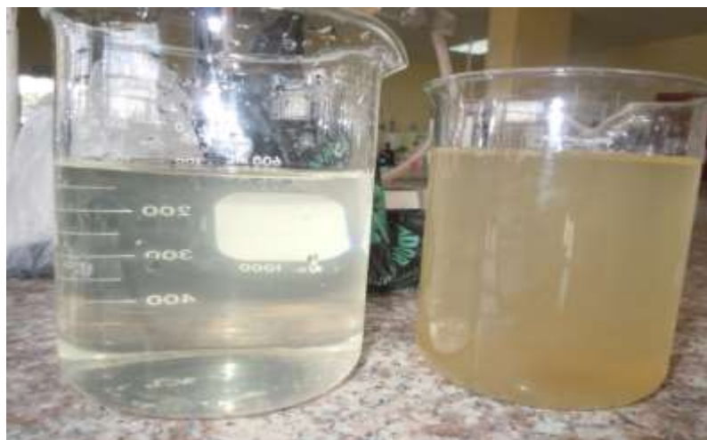
Figura 3-1 Segunda filtración con arena y grava Realizado por: Jiménez Jorge 2016
