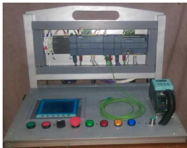
Figura 16. Tablero de redes industriales
