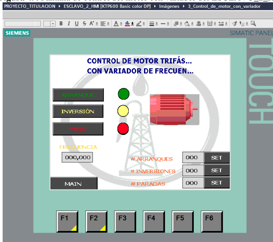
Figura 49. Pantalla de control del motor con variador del ESCLAVO_2_HM
