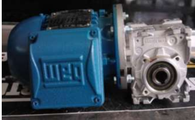
Figura 37. Montaje del motorreductor
