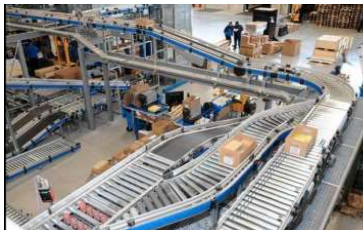
Figura 8. Sistema de transporte en líneas de ensamblaje
