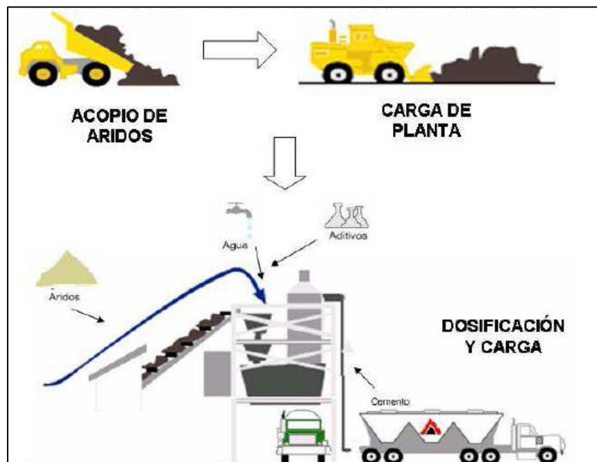
Figura 7-1. Producción de hormigón
