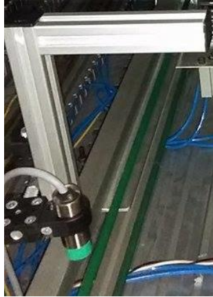
Figura 73. Montaje de sensor inductivo
