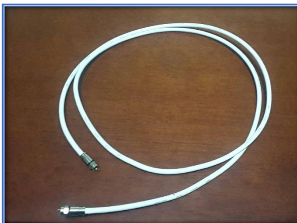
Figura 7-3: Cable coaxial construido Realizado por: HUMANANTE David & SANCHEZ Valeria, 2016
