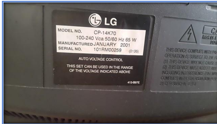
Figura 11-3: Datos de placa de la TV1 Realizado por: HUMANANTE David & SANCHEZ Valeria, 2016
