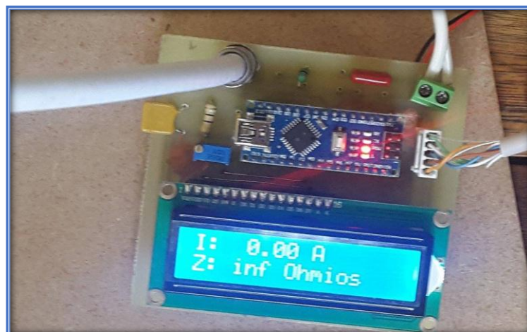
Figura 9-3: Receptor del circuito adaptador de impedancias Realizado por: HUMANANTE David & SANCHEZ Valeria, 2016
