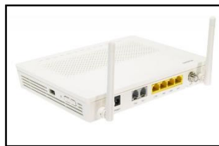
Figura 10-1 ONT (Terminal de Red Óptica)
