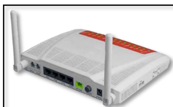
Figura 11-1 ONU (Unidad de Red Óptica)
