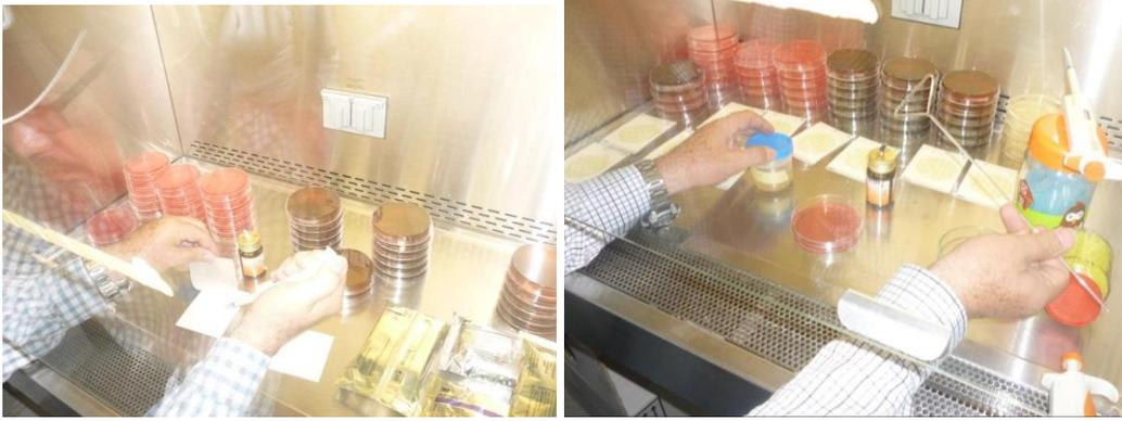
**Fotografía N° 21:** Siembra en Petrifilm para recuento de bacterias aerobias mesofilas, Mohos y levaduras, *E. coli*/coliformes, *Staphylococcus aureus*.
