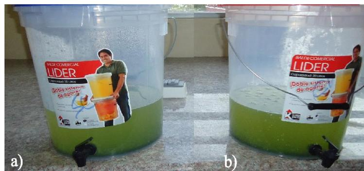
**Figura 19-3.** Sedimentación de las microalgas al cabo de 4 días:
