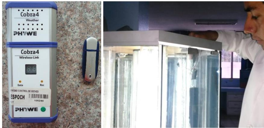
**Figura 13-3:** Medición de la intensidad lumínica utilizando un Sensor-Unit Weather Cobra 4 Weather, de marca Phywe
