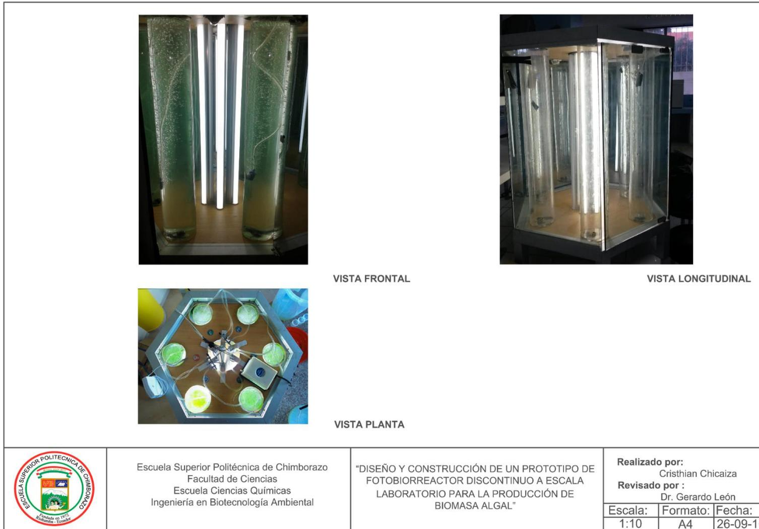
**Figura 12-3.** Vista frontal, longitudinal y de planta del prototipo de fotobiorreactor
