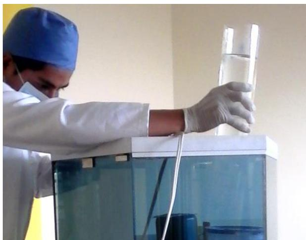
**Figura 15-3.** Colocación de los cilindros de acrílico con medios BG11 una vez inoculadas las microalgas
