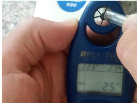
**Figura 10-3** Medición del flujo de aire con el uso de un anemómetro
