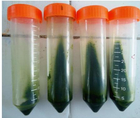
**Figura 23-3.** Separación del sobrenadante de la biomasa algal.
