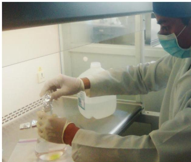
**Figura 14-3.** Preparación de medio de cultivo BG11 en una cámara de flujo laminar.
