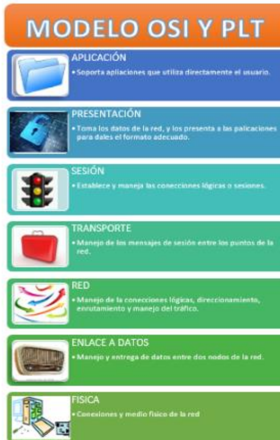
Figura III. 10 PLT y el modelo OSI
