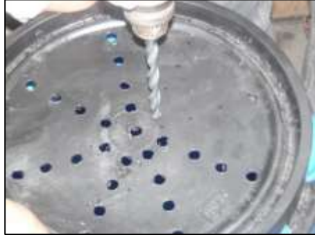
Fotografía 2-2. Tapa diseñada para filtración del agua.
