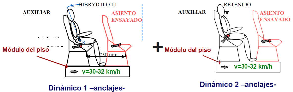
Figura 2-9. Tipos de ensayos dinámicos en anclajes de asientos.
