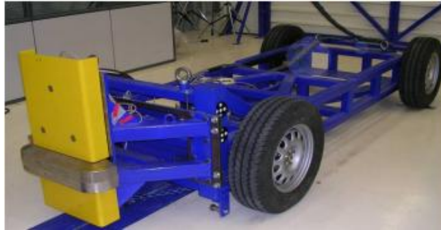
Figura 2-21. Carro impactador con barrera deformable.
