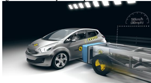
Figura 2-22. Ensayo de impacto lateral Euroncap.
