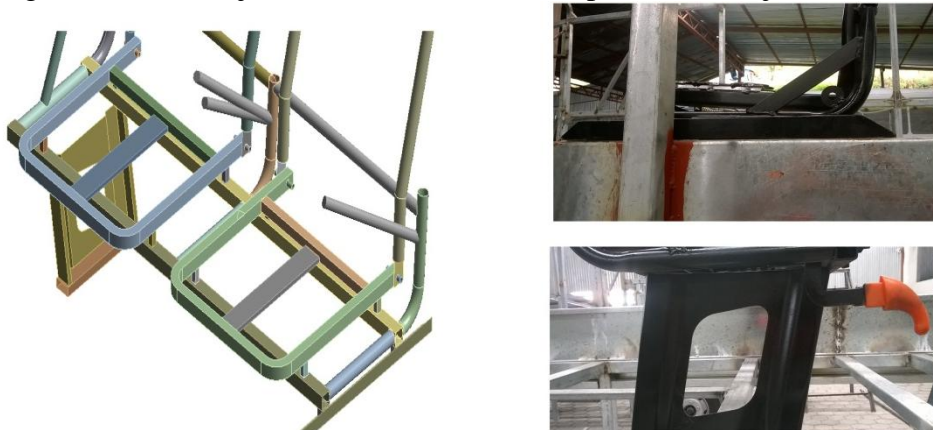
Figura 3-10. Anclajes de asiento autobús interprovincial, objeto de estudio.
