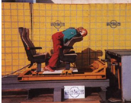
Figura 2-8. Ensayo dinámico en un asiento doble.
