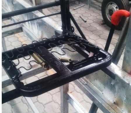
Figura 5-31. Configuración de anclaje unido al zócalo.
