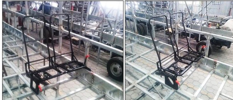
Figura 5-29. Configuración de anclajes originales y propuestos.
