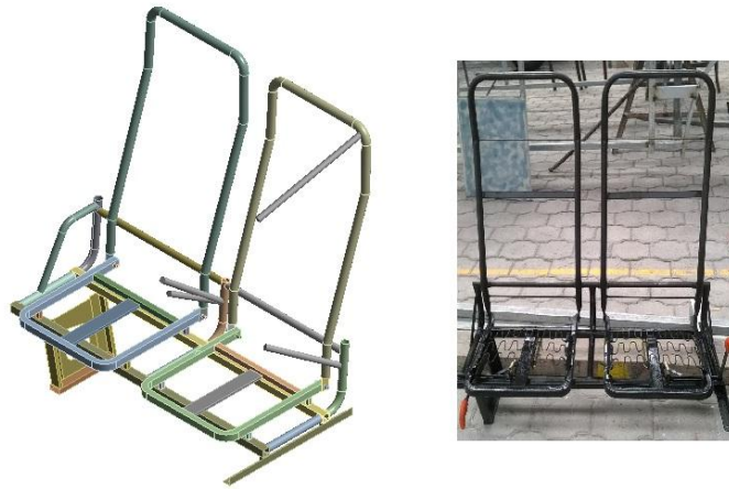
Figura 3-9. Modelo CAD y modelo real asiento autobús interprovincial.
