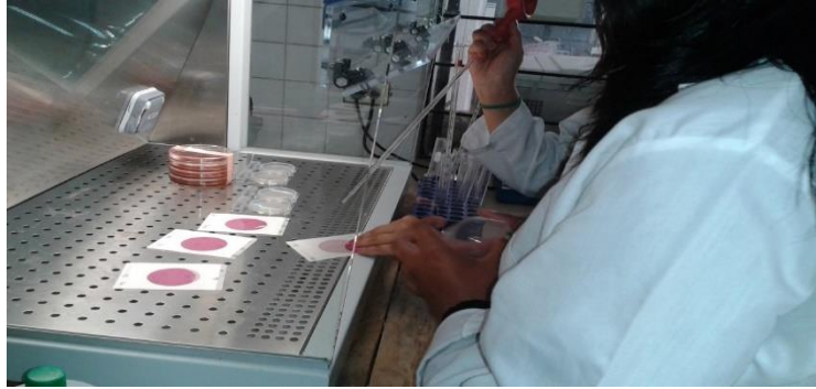
Figura 7-2: Inoculación de muestras del ensilaje en placas Petrifilm™ Realizado por: Geoconda Ch, 2016
