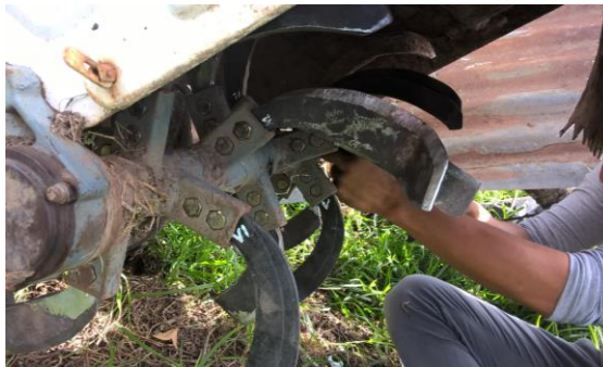
Figura 59. Finalización del montaje de cuchillas
