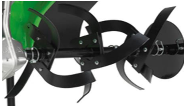
Figura 17. Disposición helicoidal de las cuchillas en una fresadora
