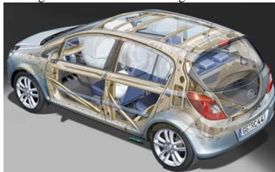
Figura 3. Elementos de la Seguridad Pasiva
