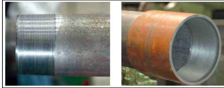
Figura 17. Pin y caja rosca redonda NU
