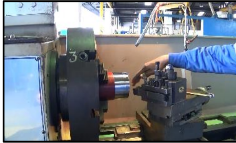
Figura 41. Roscado de pup joint (conector)
