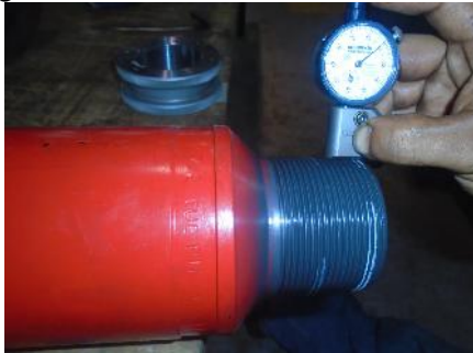
Figura 38. Medición de altura en la rosca
