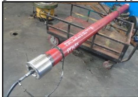
Figura 45. Prueba hidrostática en pup joint
