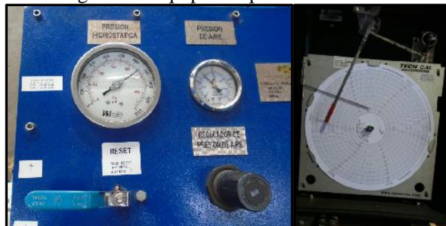
Figura 46. Equipos de pruebas hidrostáticas
