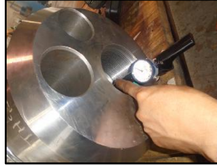
Figura 37. Medición de paso en box
