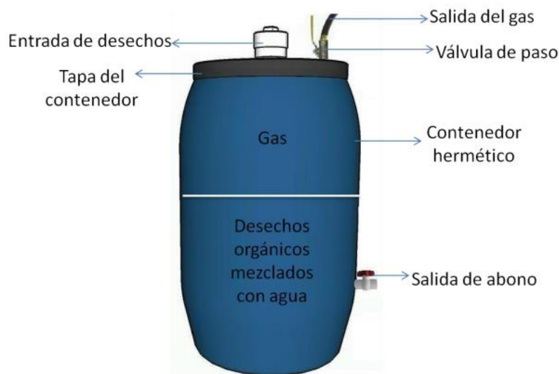
Figura 4.2 Esquema de un biodigestor
