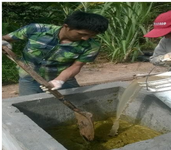
Fotografía 23 – 2: Carga del biodigestor (Estiércol+ rumen + agua).
