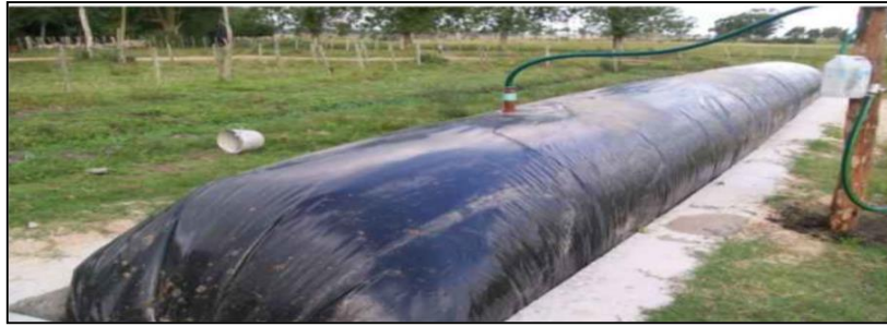
Figura 3 – 1: Biodigestor de estructura flexible
