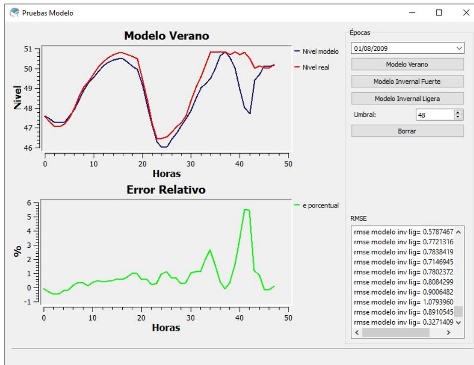
Figura 6-3: Ventana de pruebas para el modelo de la presa.
