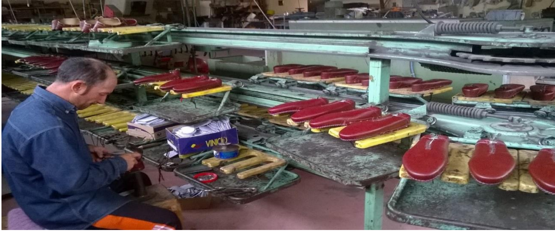
Figura 16-4. Armado y plantado
