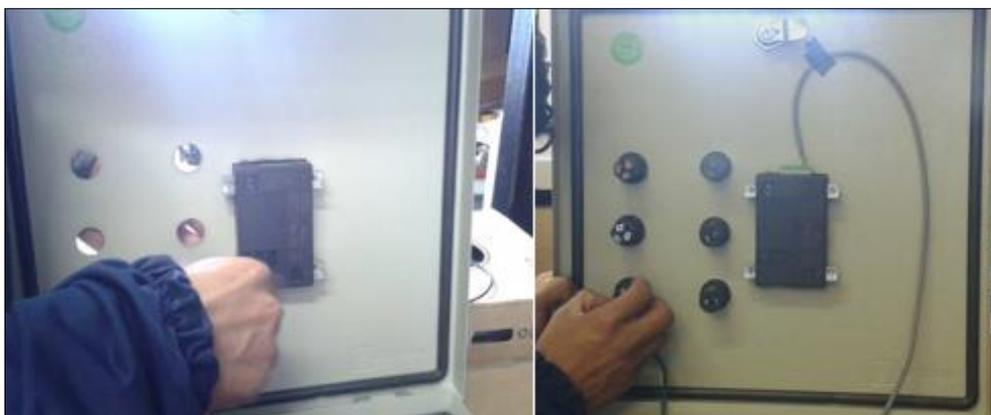
**Figura 20-2 Colocación de la pantalla HMI y botoneras**
