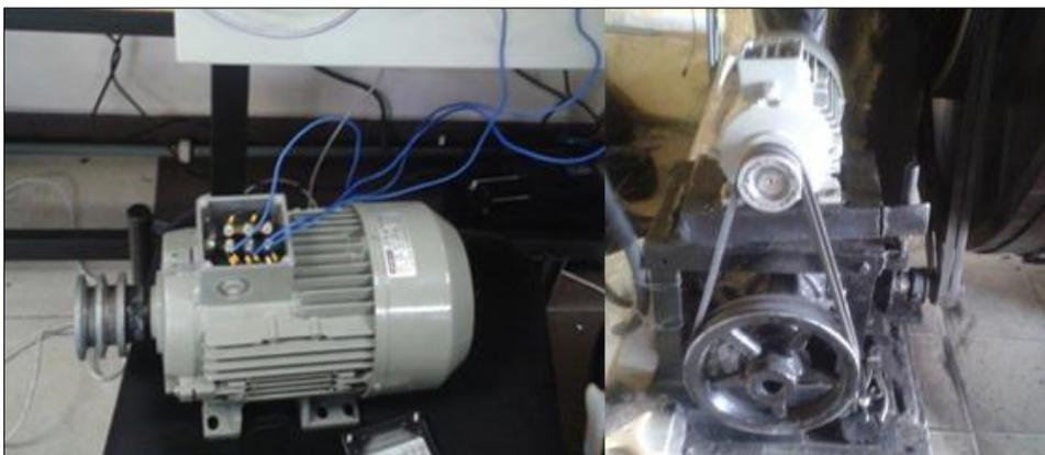
**Figura 11-2 Motor de 3HP Siemens para el reemplazo**
