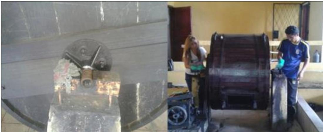
**Figura 9-2 Limpieza y engrasado de los ejes del bombo**
