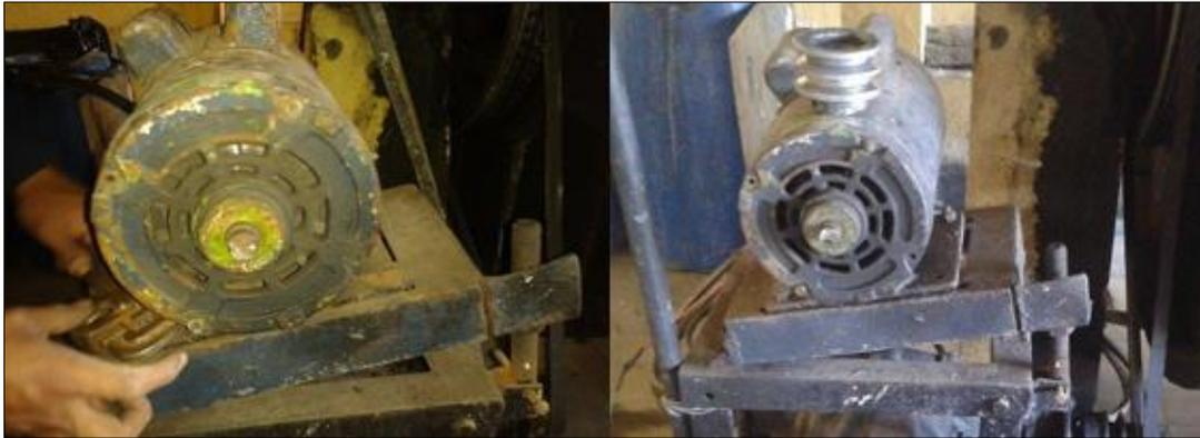
**Figura 10-2 Motor con ruptura en su eje**
