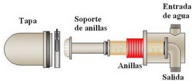
Figura 4-1 Tipo de filtro: Anillas
