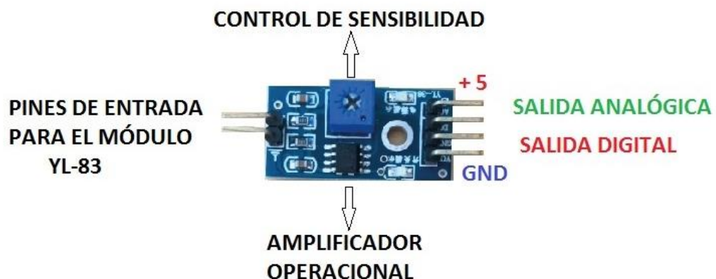
Figura 14-2 Conexión del circuito de control
