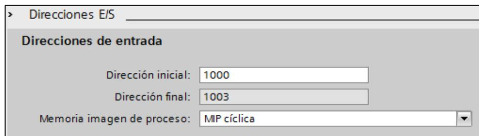
**Figura 16-3:** Dirección del contador HSC1
