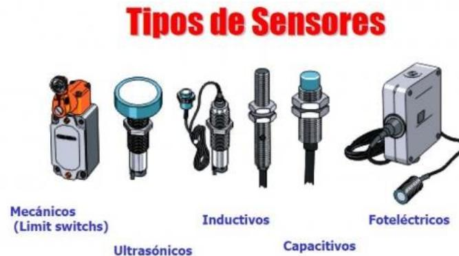
**Figura 18-1** Tipos de sensores
