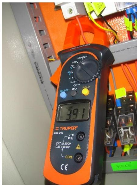
**Figura 6-3** Consumo de corriente del reactor
