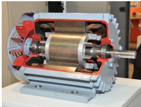
**Figura 8-1** Motor eléctrico
