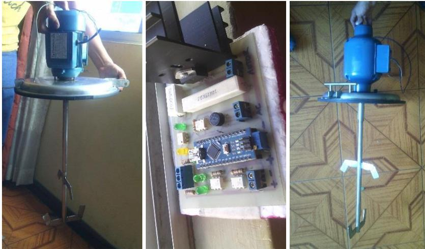
**Figura 2-3** Motor agitador y circuito de control
