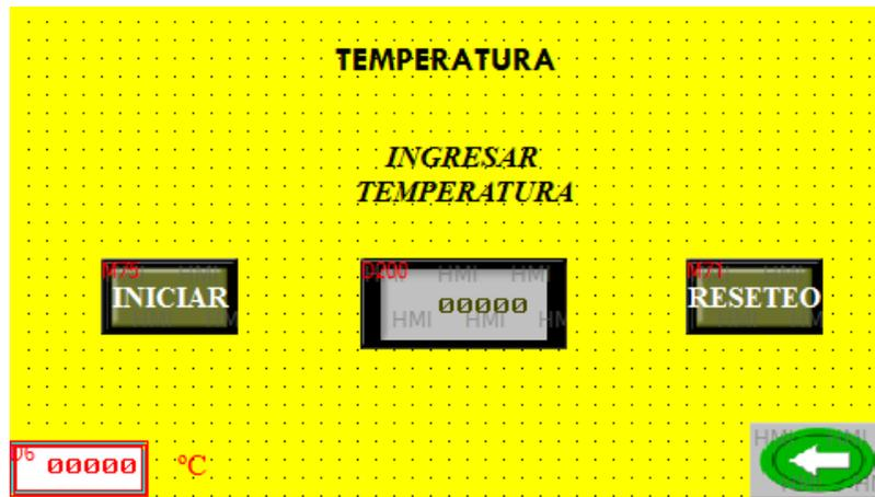
**Figura 21-2** Pantalla de ingreso de temperatura en modo manual
