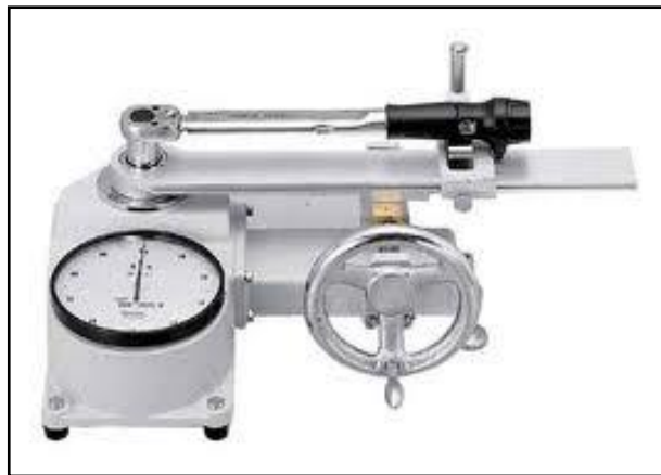
Gráfico 11-2. Patrón de calibración de torquímetro
