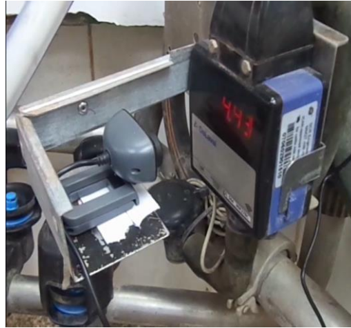
Figura 4-3. Adquisición de Datos del sistema de ordeño Fuente: Sánchez, Christian, y Pacheco, Juan, 2016
