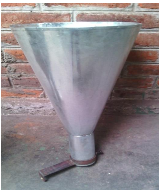
Figura 7-2. Construcción Final de la Tolva Fuente: Sánchez, Christian, y Pacheco, Juan, 2016
