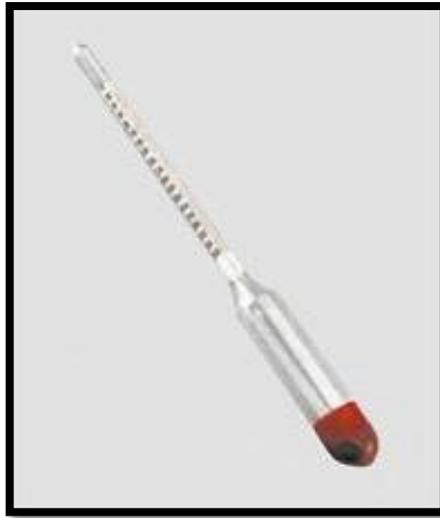
**Figura 1-1:** Alcoholímetro con escala de Gay Lussac
