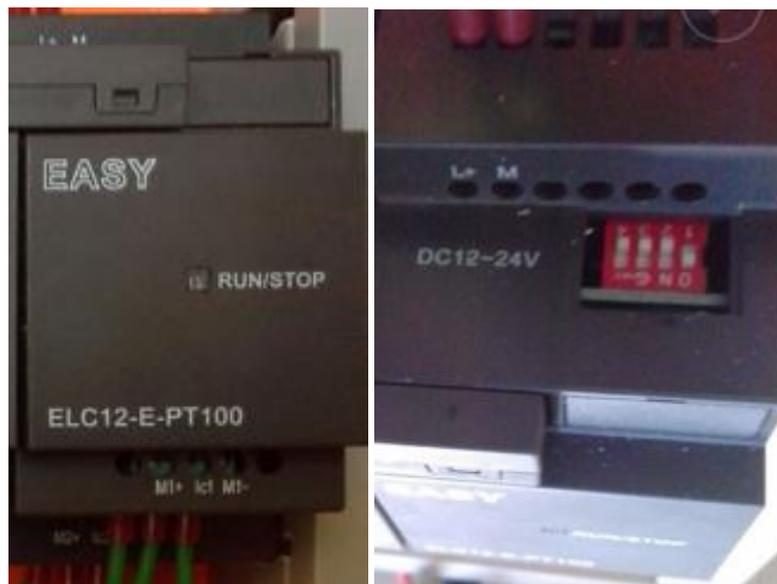
**Figura 10-2:** Configuración de la dirección del módulo de PT-100
