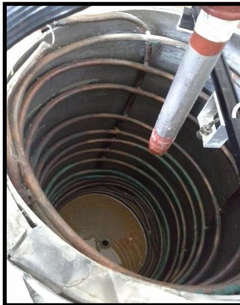
**Figura 13-3:** Recipiente del condensador
