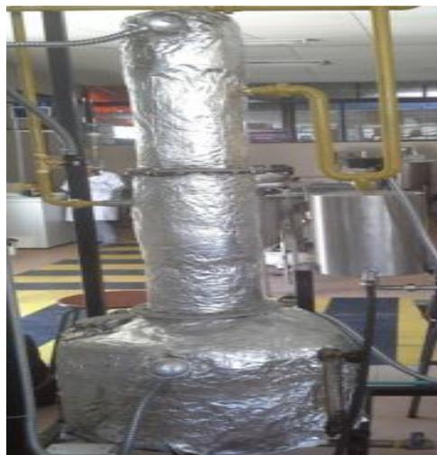
**Figura 16-2:** Torre de destilación cubierta con lana y fibra de vidrio
