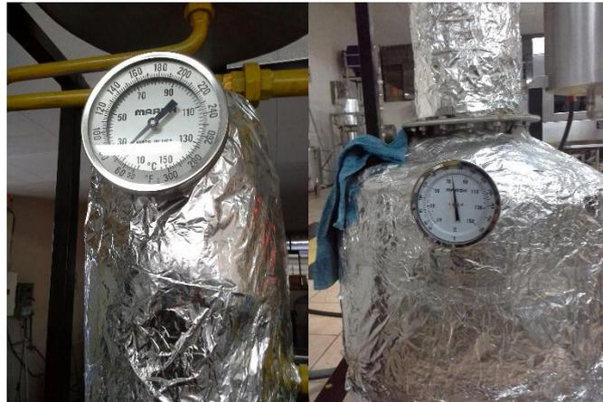
**Figura 4-3:** Sensores analógicos de temperatura
