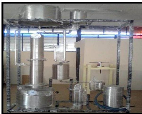
**Figura 3-1:** Torre destiladora de alcohol del laboratorio de Procesos Industriales
