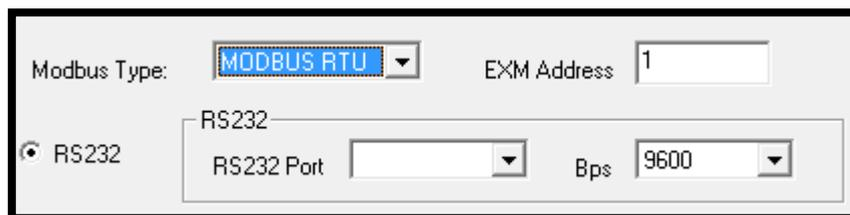
**Figura 30-2:** Configuración del puerto RS232.
