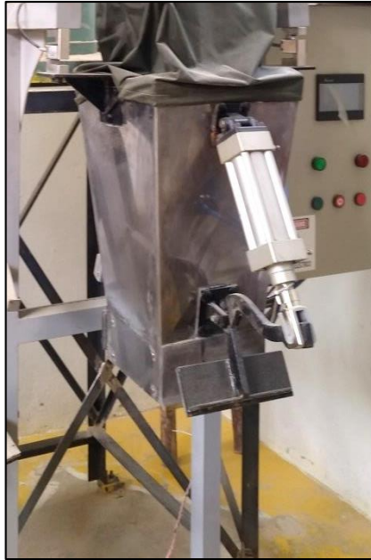
Figura 7-3 Mecanismo de sujeción de sacos. Realizado por: CALERO, Raúl; CARRILLO, Cristhyan, 2016
