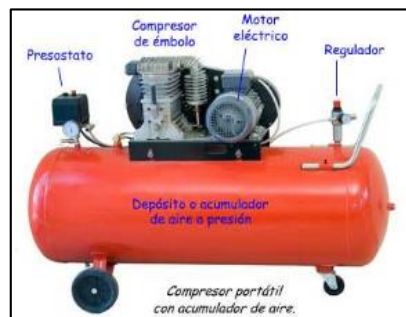
Figura 29-1 Depósito de un compresor.
