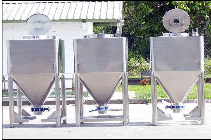
Figura 1-1 Tolvas para almacenamiento y dosificación Fuente: www.inagromecánica.com
