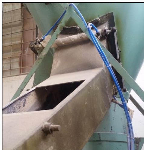
Figura 5-3 Mecanismo de compuertas.
