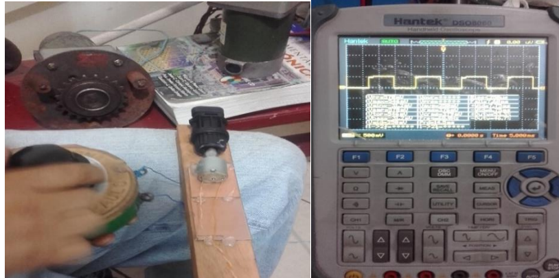
Figura 35. Prueba del sensor VSS
