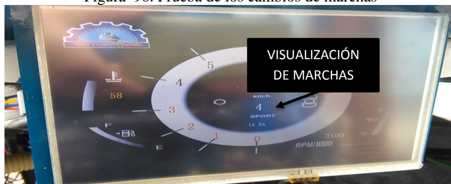
Figura 90. Prueba de los cambios de marchas
