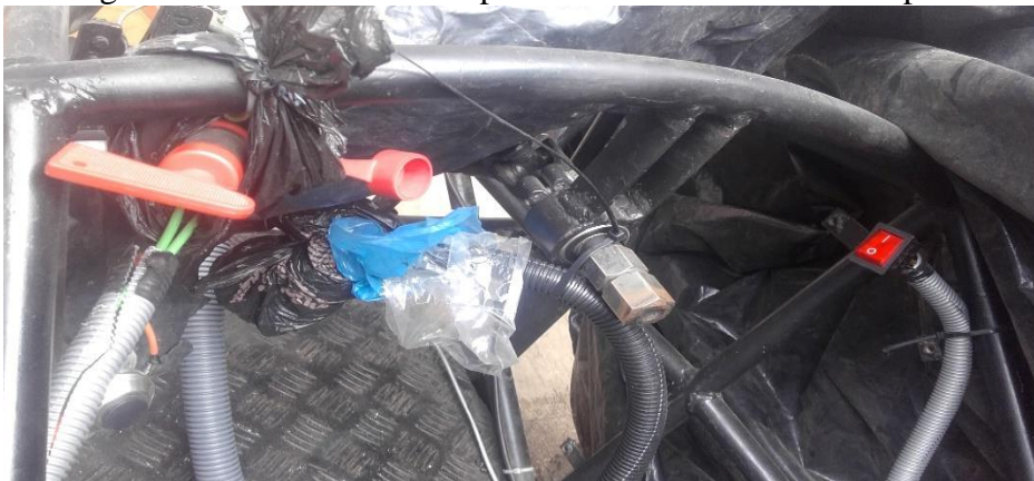
Figura 72. Botones e interruptor de encendido en el monoplaza
