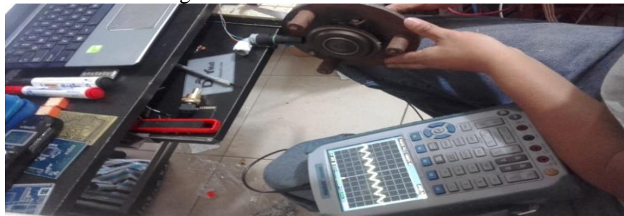
Figura 33. Prueba del sensor CKP
