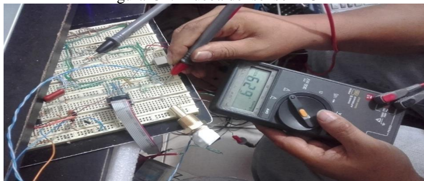
Figura 34. Prueba del sensor ECT
