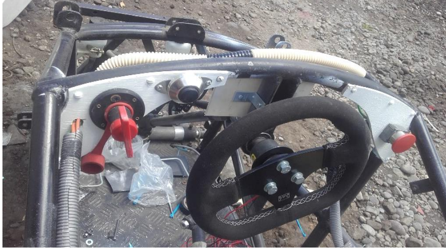
Figura 73. Posicionamiento de los botones e interruptor de encendido
