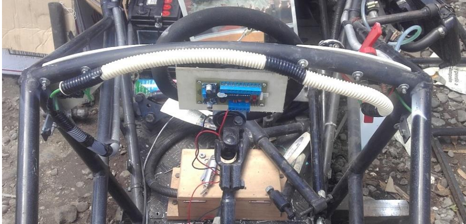
Figura 71. Posicionamiento de la placa en el monoplaza
