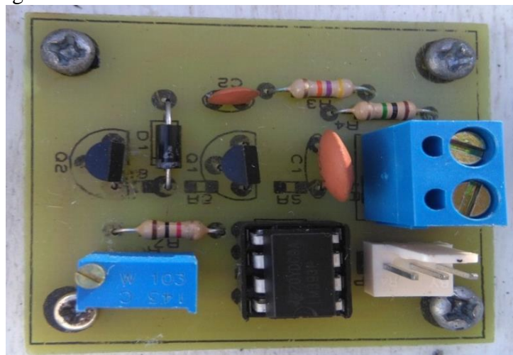
Figura 80. Placa electrónica de convertidor de onda
