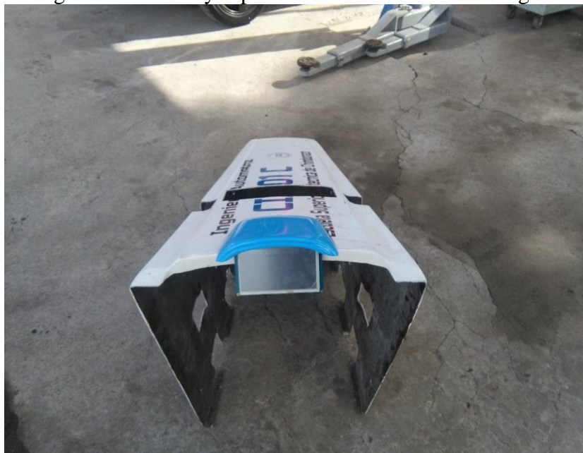
Figura 82. Visera y soporte del tablero electrónico digital
