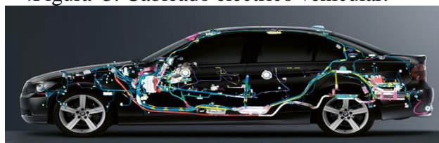
.Figura 3. Cableado eléctrico vehicular.
