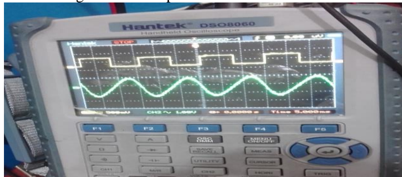
Figura 38. Comparación de señales del CKP
