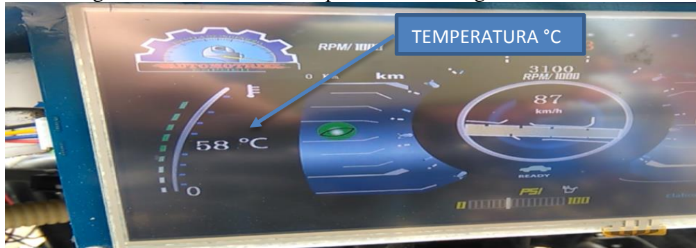
Figura 89. Prueba de la temperatura del refrigerante del motor
