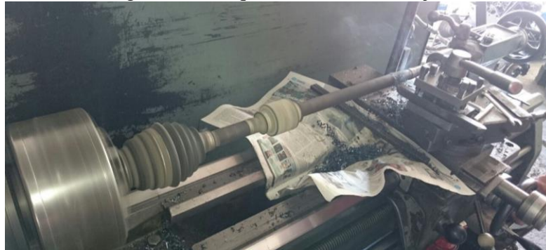
Figura 40. Maquinado de los semiejes
