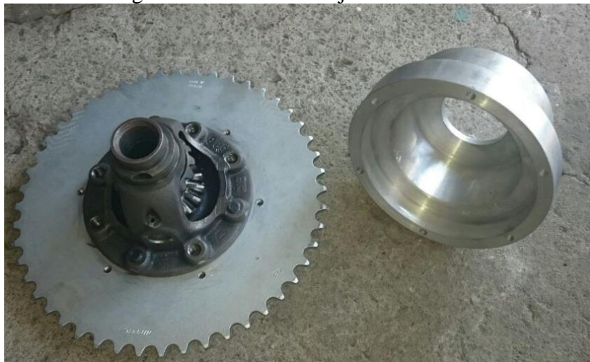
Figura 35. Partes del conjunto diferencial
