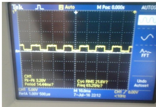
Figura 95. Señal del sensor de distancia transmitiendo
