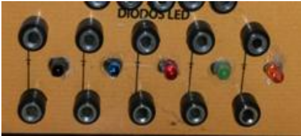
Figura 61. Instalación de los diodos LED parte externa
