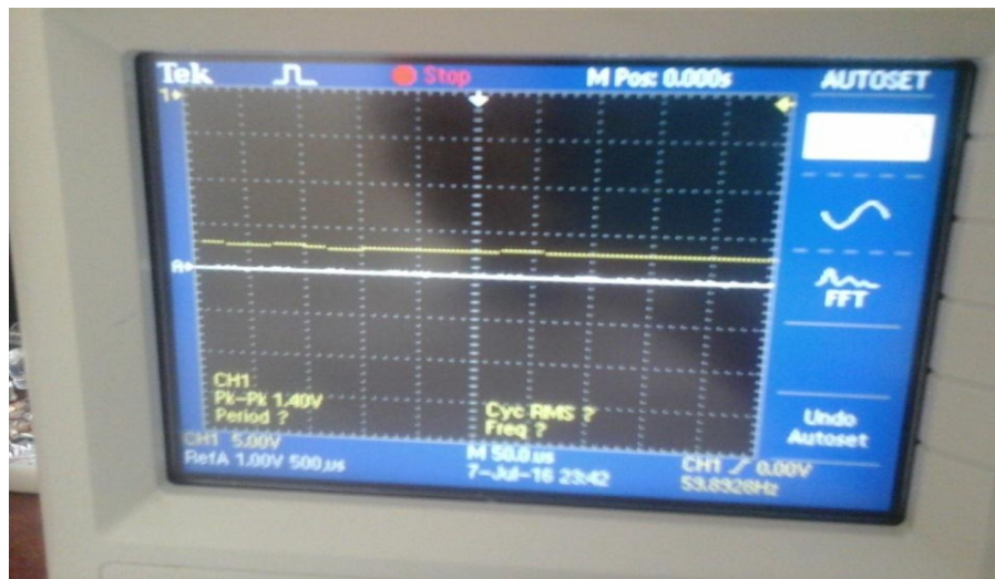
Figura 104. Onda del sensor de temperatura sin temperatura
