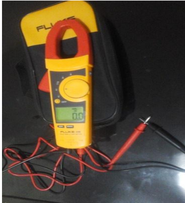
Figura 71. Pruebas de funcionamiento de la pinza amperimétrica
