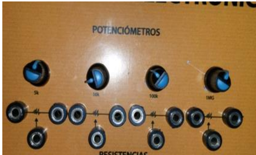
Figura 57. Instalación de los potenciómetros parte externa
