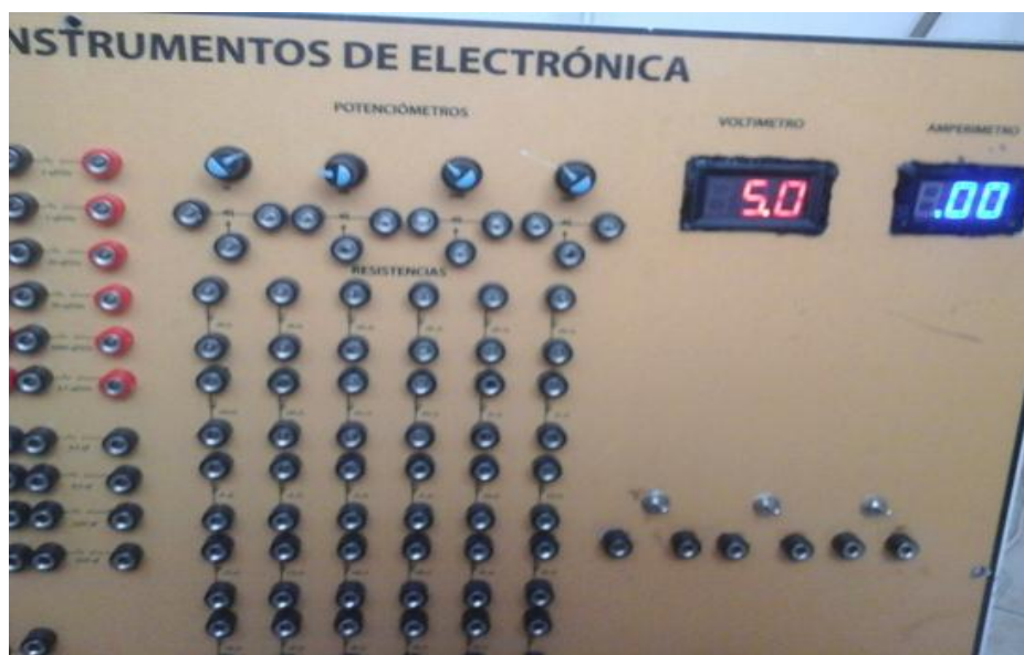
Figura 102. Fuente de poder regulada a 5V
