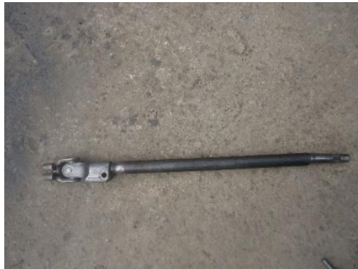
Figura 68. Columna de dirección.
