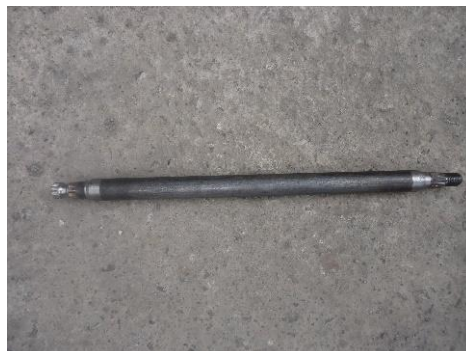
Figura 27. Columna de dirección.
