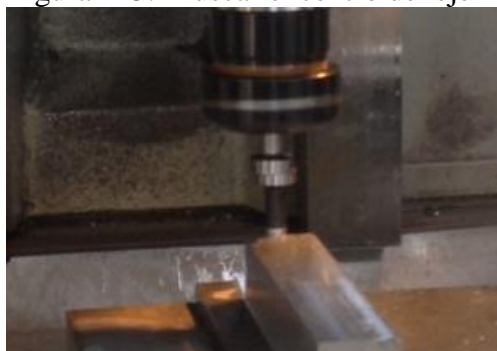
Figura 115. Buscar el centro del eje Y
