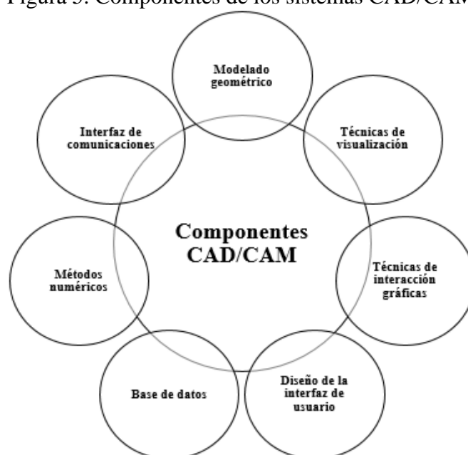
Figura 5. Componentes de los sistemas CAD/CAM
