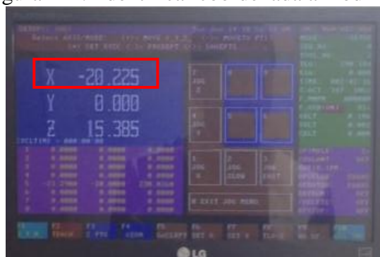
Figura 121. Identificar coordenada a modificar
