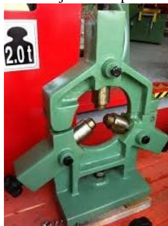
Figura 33. Sujeción de piezas largas
