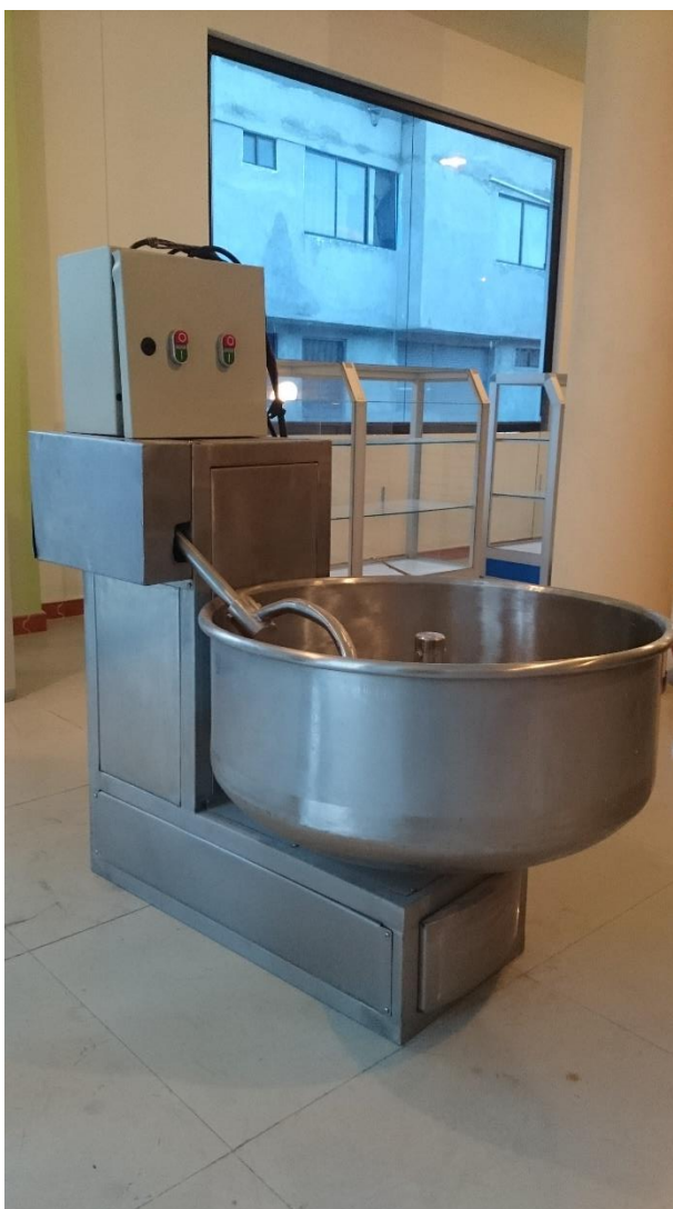
Gráfico 7. Prototipo semiautomático para el hilado del queso mozzarella.
