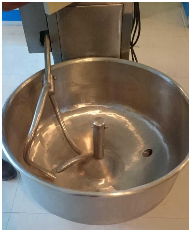
Gráfico 5. Vista de la tina e hilador del prototipo semiautomático para el hilado del queso mozzarella.
