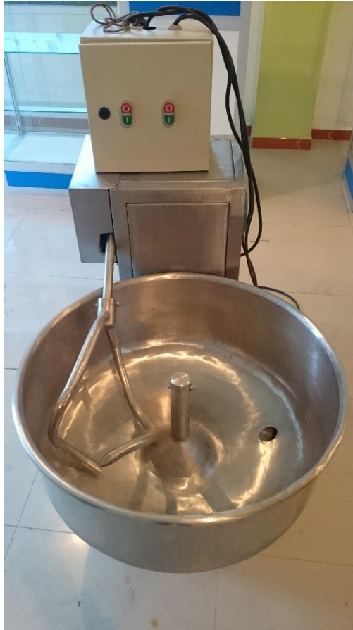
Gráfico 6. Vista del control de mandos del prototipo semiautomático para el hilado del queso mozzarella.
