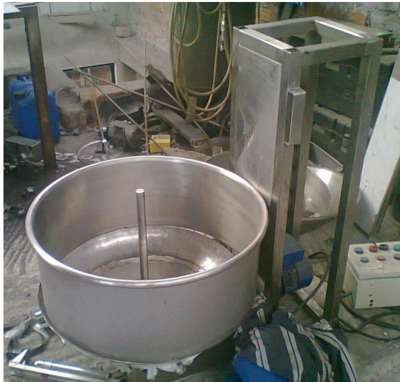
Gráfico 4. Vista de la estructura del cuerpo del prototipo semiautomático para el hilado del queso mozzarella.
