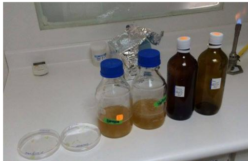
PASO 3: Se conserva 24h el agua de peptona con la bacteria y con gotas de crudo
