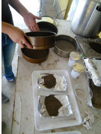
PASO 1: Tamizado del suelo seco.
