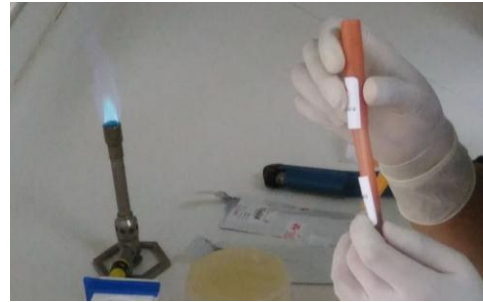
PASO 4: Se rompe una capsula y baja el líquido enriquecido que contiene las bacterias
