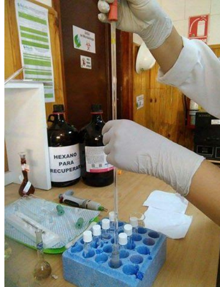
PASO 2: Colocando 10mL a los 2g de suelo con 0,3 de silica y 0,5 se Sulfato de sodio \text{Na}_2\text{SO}_4 .
