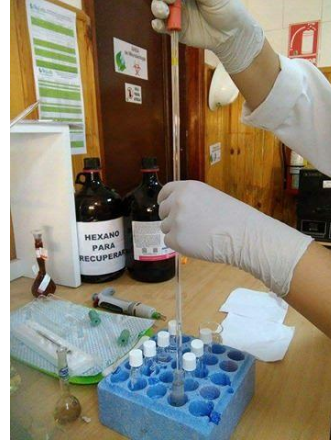
PASO 2: Colocando 10mL a los 2g de suelo con 0,3 de silica y 0,5 se Sulfato de sodio \text{Na}_2\text{SO}_4 .
