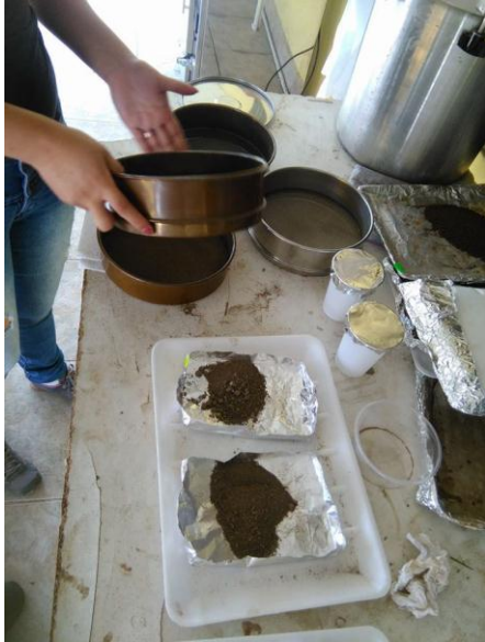
PASO 1: Tamizado del suelo seco.
