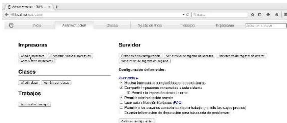
Figura 2-6. Instalación de las impresoras en el servidor.
