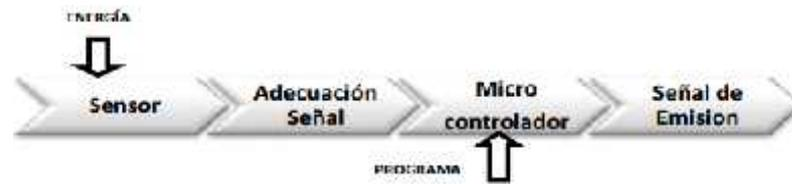
**Figura 4-1** Componentes de una red de sensores inalámbricos.
