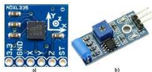
**Figura 7-3** Sensores a) ADXL 335 b) Módulo 420 sw
