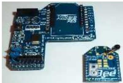
**Figura 6-3** XBee S2 y Shield XBee compatible con Arduino MEGA 2560
