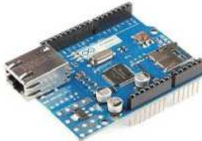
**Figura 16-1** Módulo de comunicación Ethernet de Arduino
