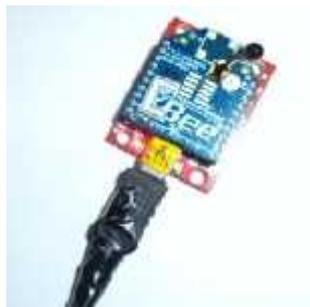
**Figura 11-3** Acceso al XBee S2 a través del XBee Explorer
