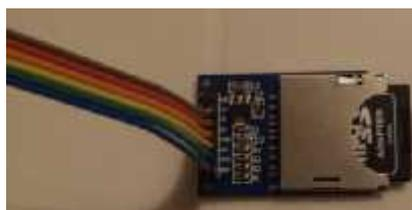
**Figura 9-3** Módulo lector de tarjetas SD para conectar con Arduino, de la marca LC Studio
