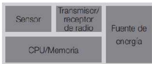
**Figura 3-1** Dispositivo autónomo de una red de sensores inalámbricos.
