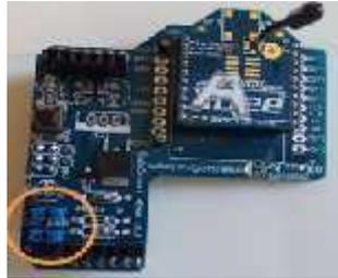
**Figura 13-3** Jumper del Shield XBee, configuración para que el Arduino MEGA y el XBee utilicen el mismo puerto
