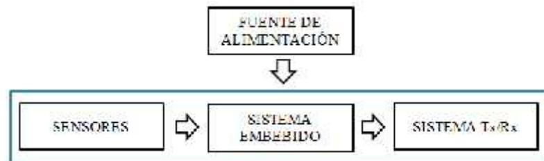
**Figura 3-2** Diagrama de bloques nodo sensorial
