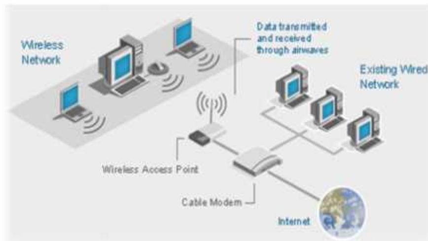
**Figura 1-1** Esquema gráfico de una 802.11 WLAN
