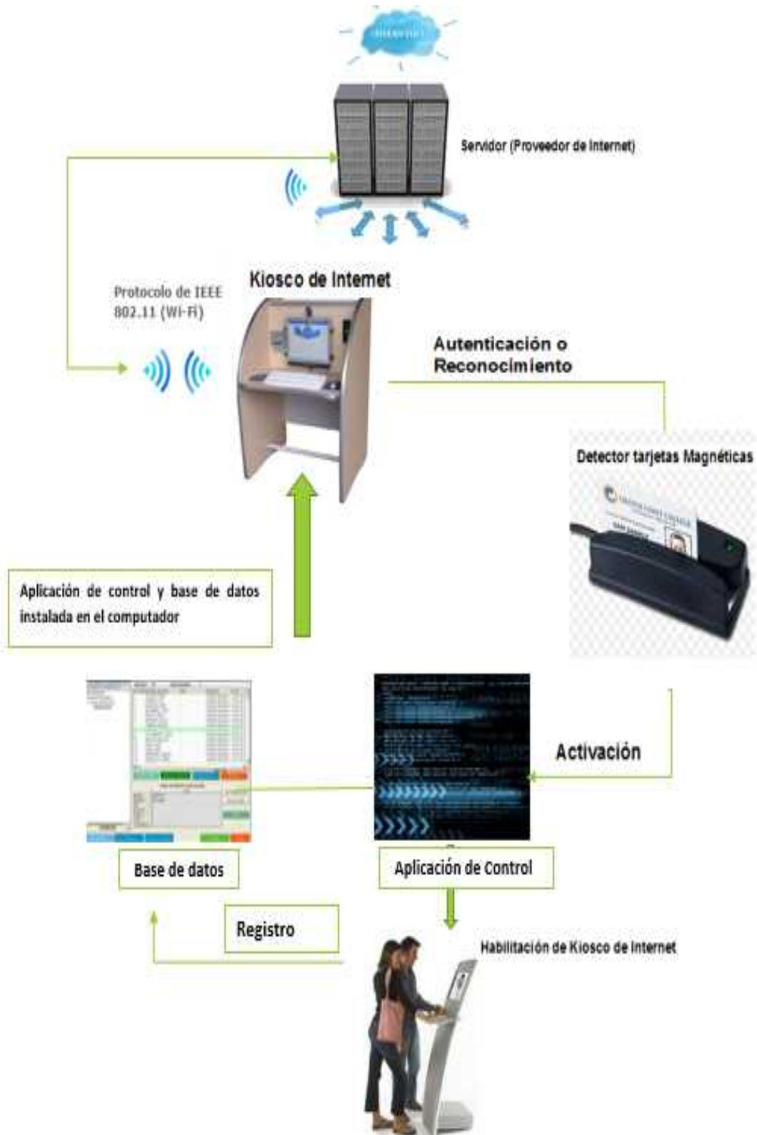
**Figura 3-2** Diagrama del proceso de funcionamiento del Kiosco Tecnológico
