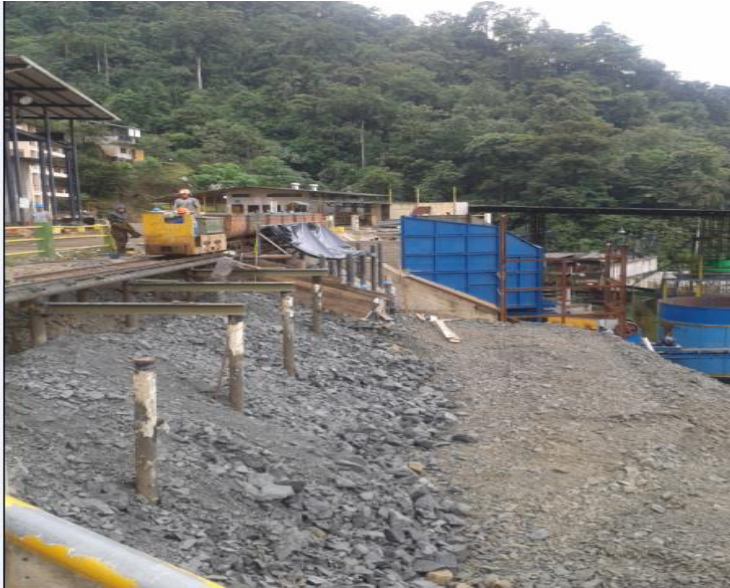
Fotografía 4-2: Transporte del material con locomotoras a baterías. Elaborado por: Ríos Wilmar. (2016)
