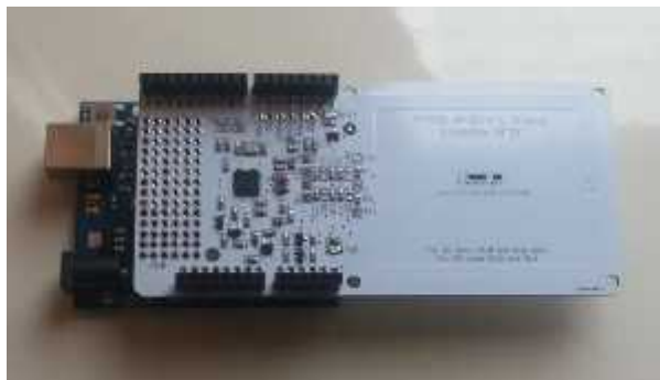
Figura 3-2: Conexión entre Arduino UNO y Adafruit PN532 RFID/NFC Realizado por: Albuja J., Yépez J, 2016.
