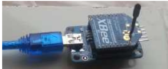
Figura 9-2: Conexión Xbee S1 con Xbee Explorer USB
