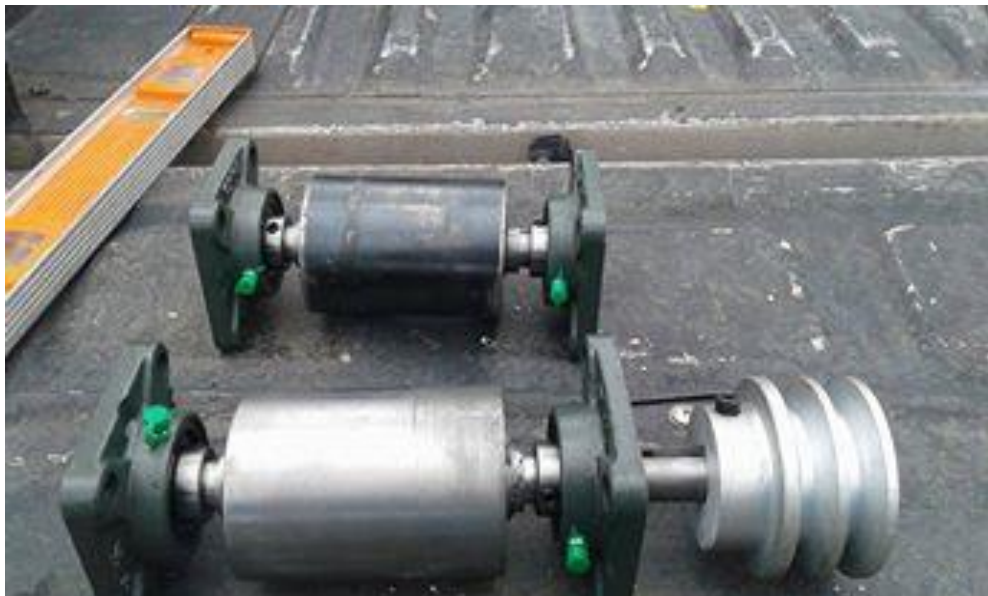
REGULADOR DE TENSIÓN DE BANDA
