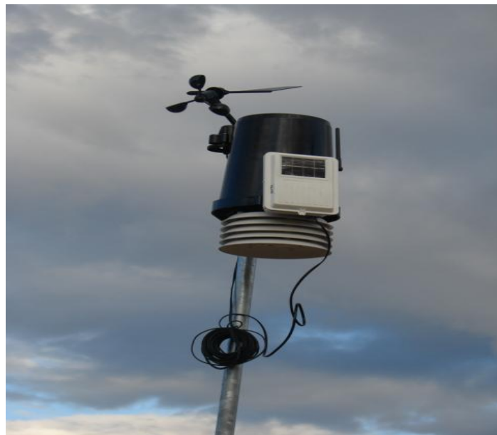
Fotografía 31: TORRE DE MEDICIÓN DE VIENTO A 10 METROS DE ALTURA
