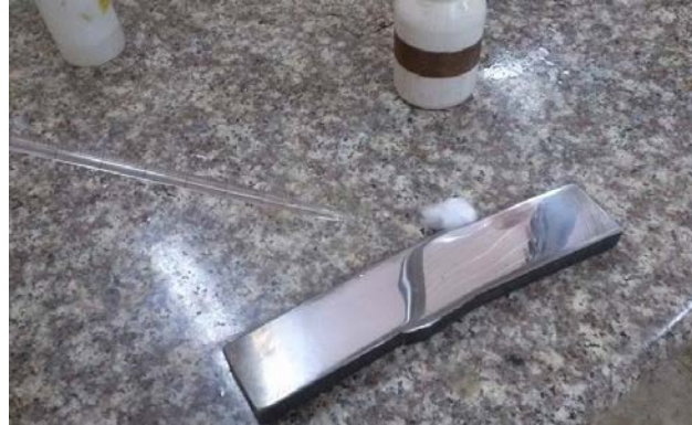
Figura 48. Ataque químico de las probetas con Nital al 2%
