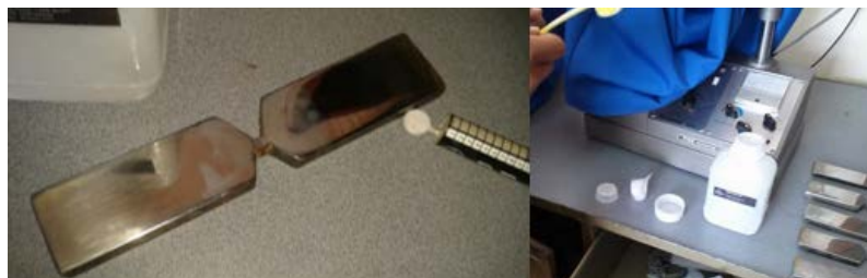
Figura 45. Aplicación de la pasta de diamante en las probetas GMAW STT y GMAW STT SAW TANDEM
