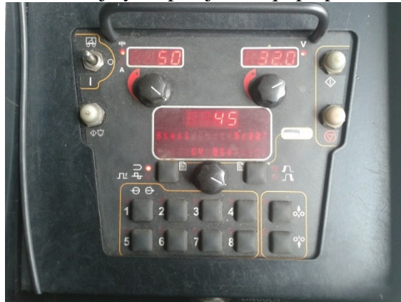
Figura 37. Selección de voltaje y amperaje en equipo para soldadura GMAW STT
