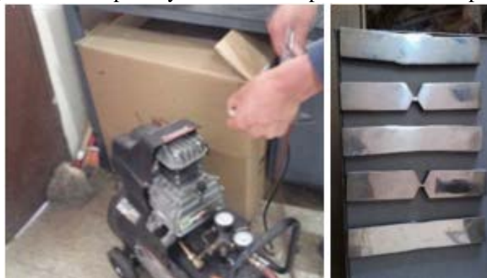
Figura 49. Limpieza y secado de las probetas con compresor
