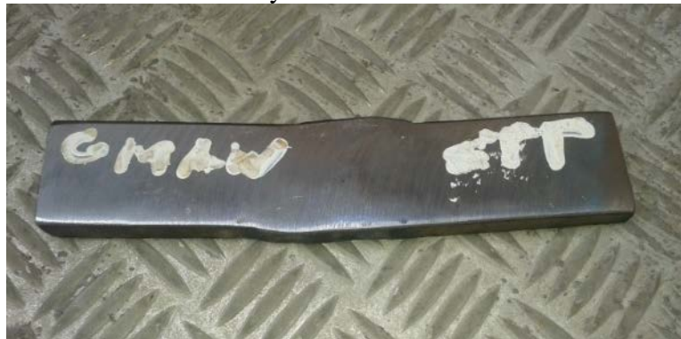
Figura 47. Probeta 2 con corte transversal utilizando el proceso de soldadura GMAW STT y SAW TANDEM
