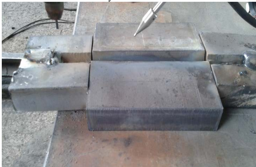
Figura 27. Placa con pase de soldadura GMAW STT para Elaboración de probetas para ensayos destructivos
