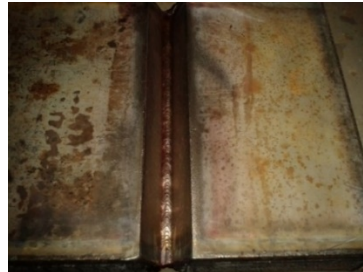
Figura 18. Limpieza del área del cordón de soldadura GMAW STT
