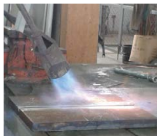
Figura 14. Pre-calentamiento de la probeta para aplicación de PT en el pase de raíz en la soldadura GMAW STT
