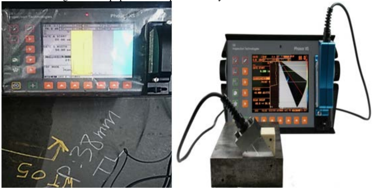
Figura 24. Equipo utilizado para el Ensayo de Ultrasonidos
