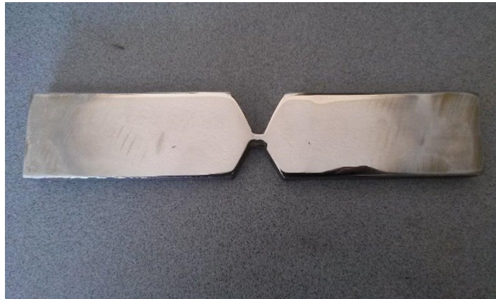
Figura 46. Probeta 1 con corte transversal utilizando el proceso de soldadura GMAW STT
