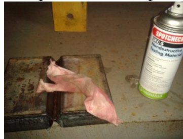
Figura 16. Aplicación del limpiador SKC-S
