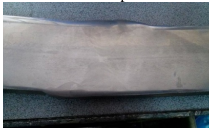
Figura 60. Muestra de soldadura con pase de raíz GMAW STT + SAW
