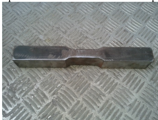
Figura 30. Probeta de placas soldadas de acero A 537 Cl 1 para ensayo de tracción
