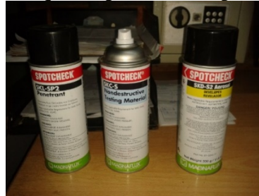
Figura 15. Kit de pruebas para líquidos penetrantes (penetrante, limpiador y revelador)
