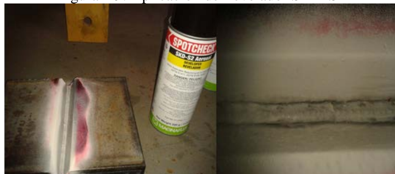
Figura 19. Aplicación del revelador SKD-S2
