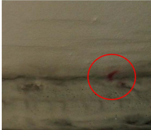
Figura 21. Discontinuidad observada en la ranura del cordón de soldadura GMAW STT
