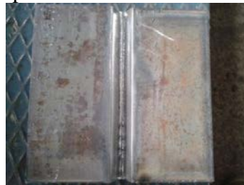
Figura 13. Vista superior del cordón de soldadura GMAW STT
