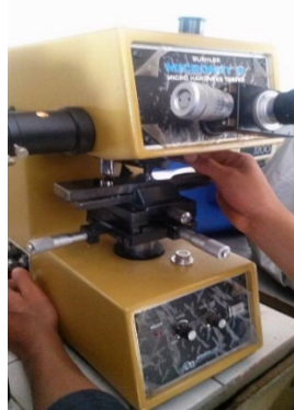
Figura 73. Ensayo de microdureza Vickers en placas de pase de raíz GMAW STT Acero A537 Cl 1
