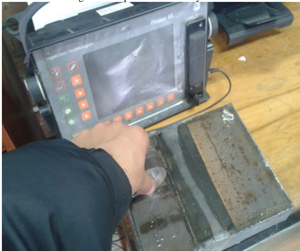
Figura 25. Aplicación del ensayo de UT
