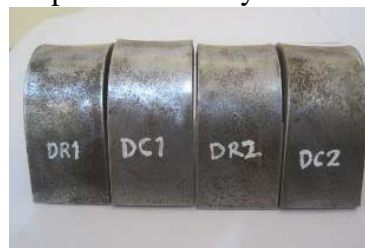
Figura 34. Probeta aplicada el ensayo de doblado GMAW STT
