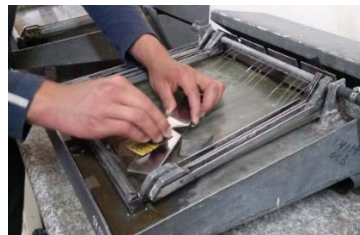
Figura 44. Preparación de superficies en la porta lija de las probetas GMAW STT y GMAW STT SAW TANDEM
