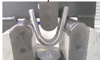
Figura 33. Ensayo de doblado en probetas con soldadura GMAW STT
