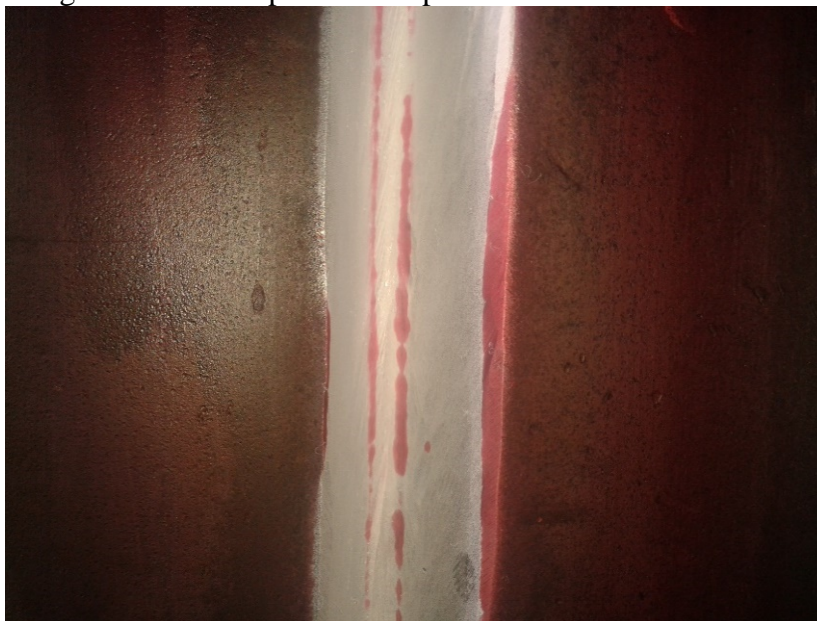
Figura 23. Tintas penetrantes proceso de soldadura SMAW
