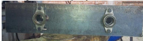
Figura 60. Montaje soporta motores
