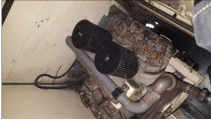
Compresor de la locomotora
