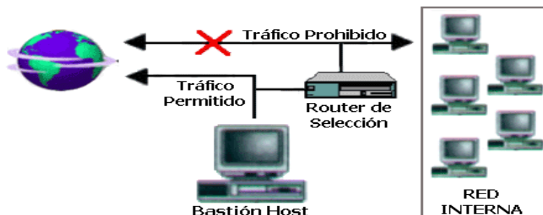
Ilustración N° 5: Combinación Router con host bastión
