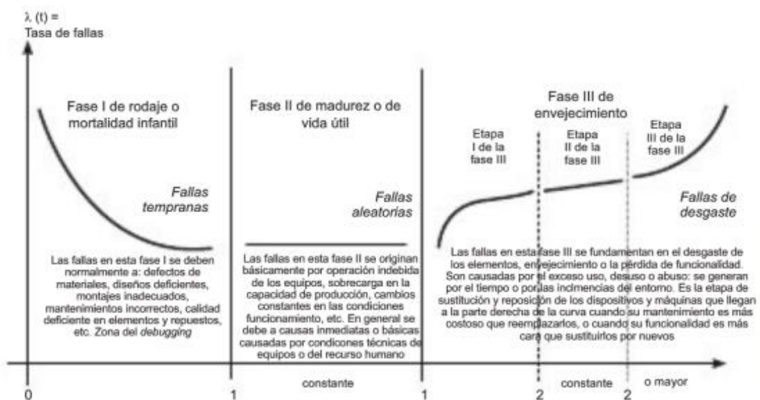
FIGURA 22-2. Fases de Curva de la bañera o de Davies Fuente: (Mora Gutiérrez, 2009)
