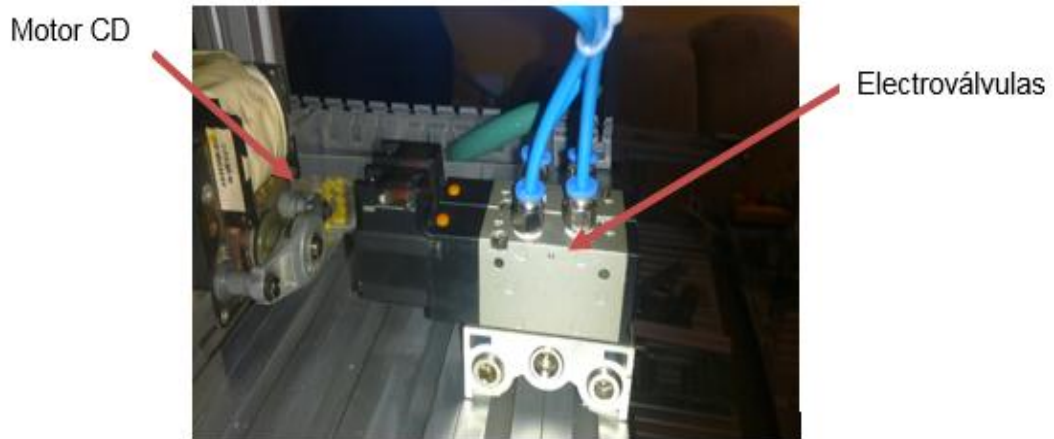
Figura 20. Partes del circuito neumático
