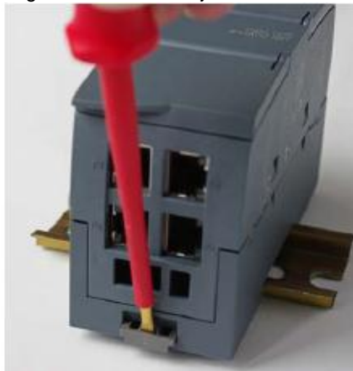
Figura 36. Desmontaje del CSM 1277
