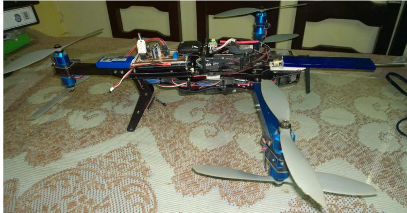
Figura. 88-4: Drone acoplado con la estación meteorológica portátil.
