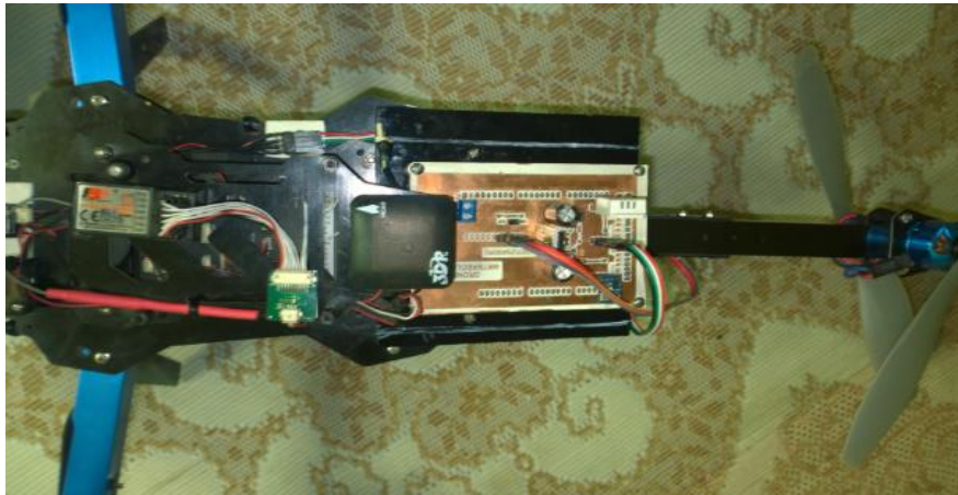
Figura. 85-4: Placa de sensores incorporada en la parte superior del Drone.
