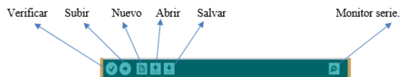
Figura. 45-2: Esquema de herramientas del Software Arduino.
