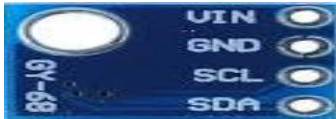
Figura. 3-2: Sensor de Presión Atmosférica, Temperatura y Altura BMP180
