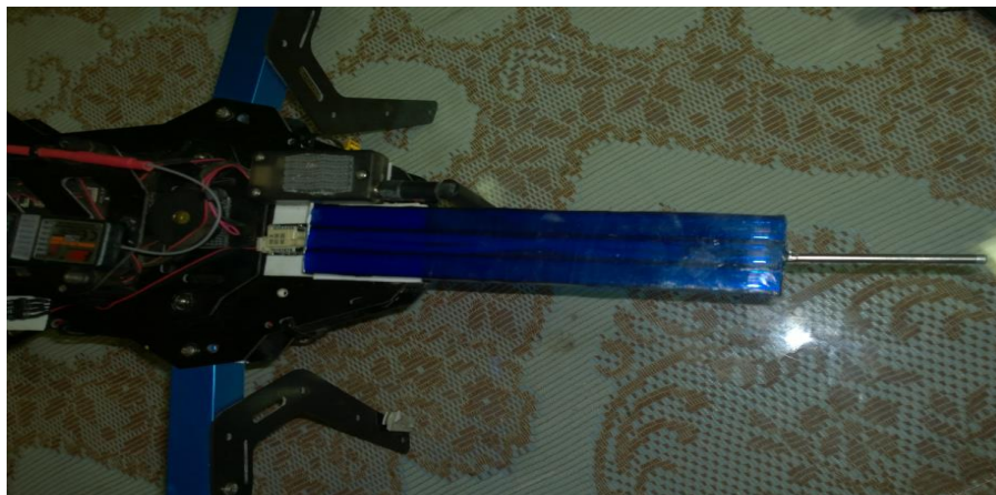
Figura. 86-4: Implementación del sensor de velocidad del viento en la partes frontal.
