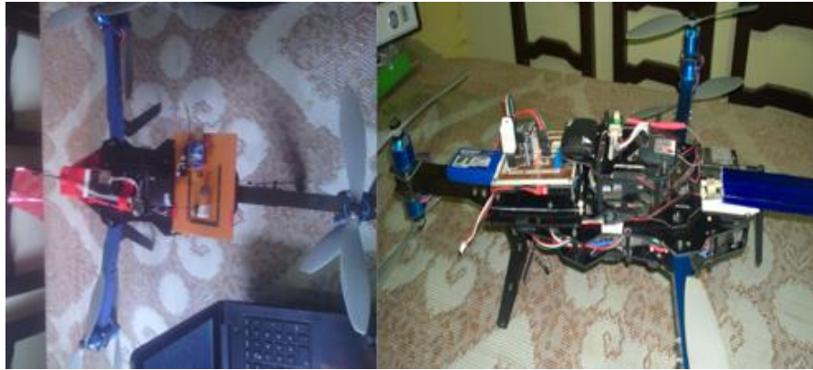
Figura. 103-4: Corrección de la ubicación de los módulos Xbee.
