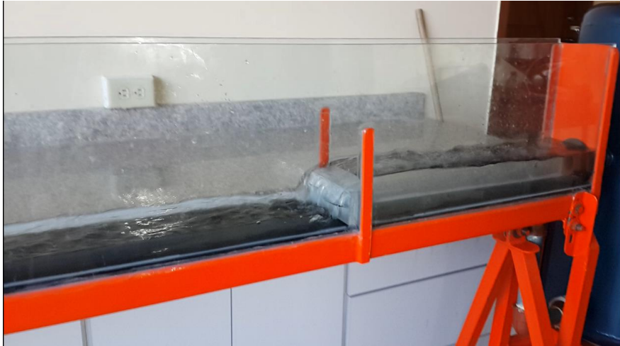
Fotografía 14. Práctica con el vertedero rectangular (Resalto Hidráulico)
