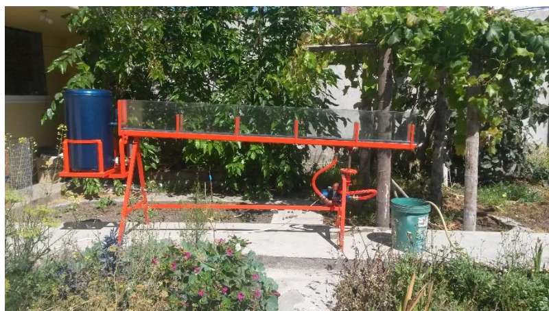
Fotografía 11. Equipo completo para medición de parámetros hidráulicos
