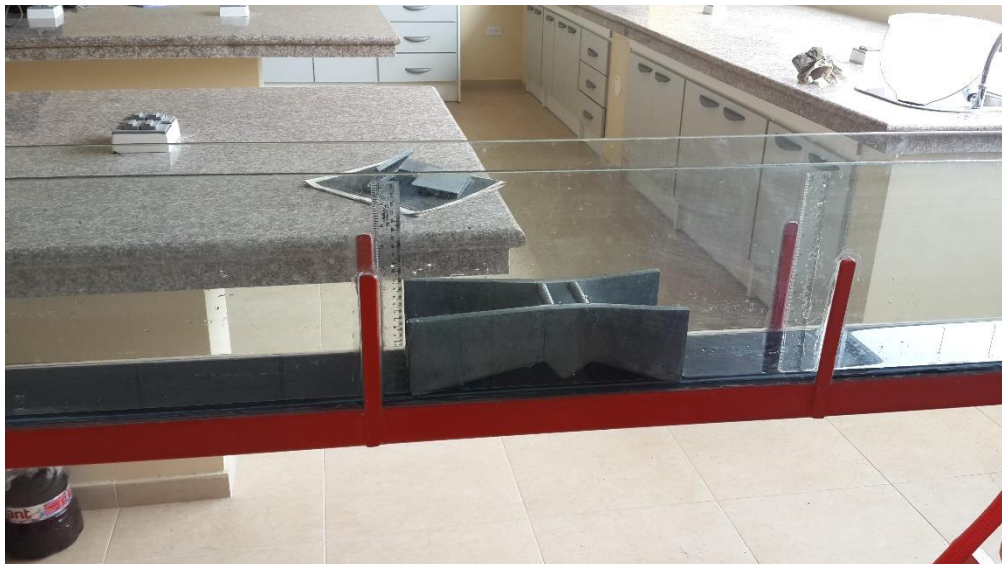
Fotografía 15. Práctica con el canal Parshall
