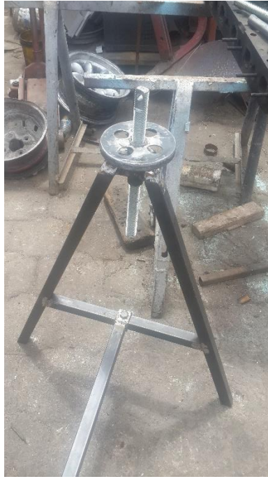
Fotografía 5. Rodela y torniquete para pendiente de inclinación
