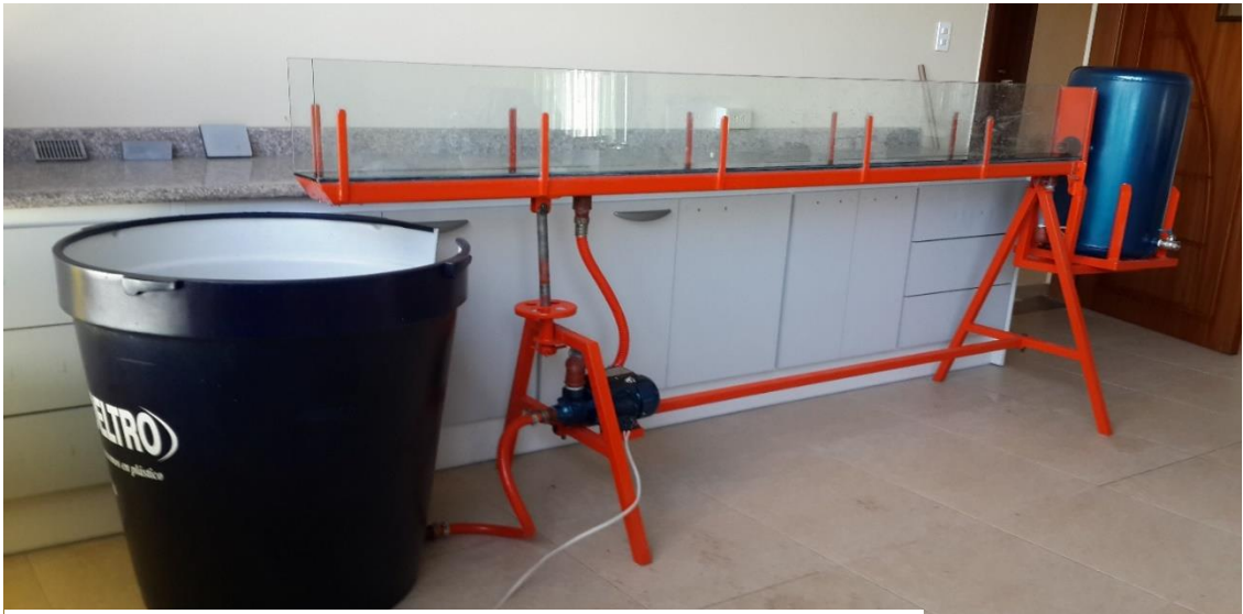
Fotografía 1-3: Equipo para medición de parámetros hidráulicos
